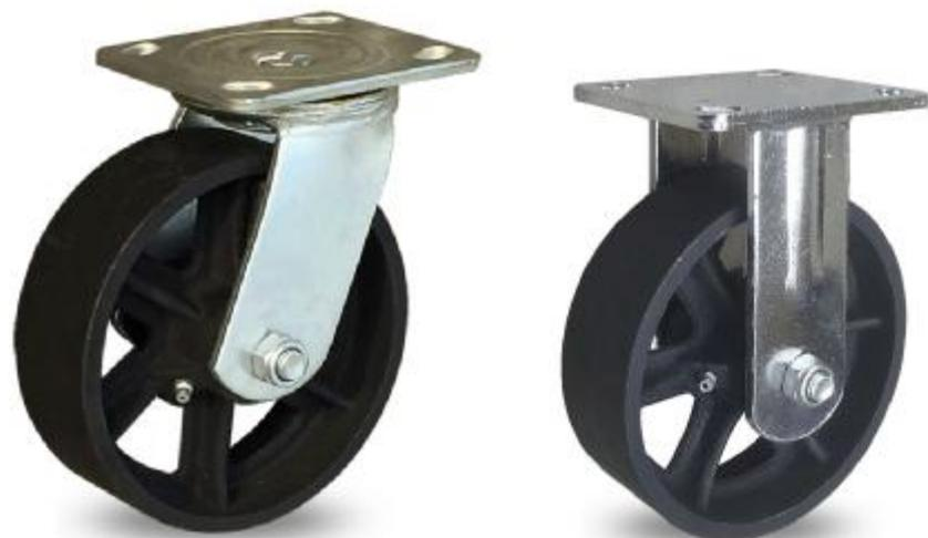
铸铁脚轮具有负载能力强、使用寿命长、耐高温性能优的特点，是仓储、物流及各厂家设备用脚轮的理想选择。但铸铁脚轮韧性差，超负荷工作会引起轮子碎裂，所以一般只适用于轻型和中重型设备用。重型设备需要考虑球铁轮脚轮和锻钢轮脚轮。因为铸铁脚轮具有超强的硬度，会对地面产生压痕，所以轻型铸铁脚轮可适用于木质地面，中重型铸铁脚轮可以应用于硬化光滑的混凝土路面。铸铁脚轮不适用于对地面有保护要求的场所。
